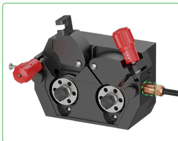
(4) Serrare la vite per fissare l'ugello.
